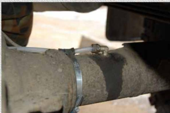
7. На переднем мосту фиксируем трубку хомутом перед тормозными шлангами.
