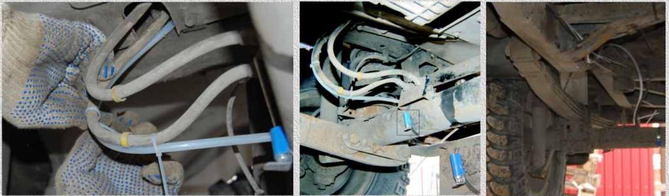
10. При помощи гибких стяжек скрепляем гибкий тормозной шланг и трубку от сапуна на переднем мосту и выводим в подкапотный отсек. На заднем мосту проводим шланг по левому лонжерону рамы (если смотреть против движения) до моторного отсека, закрепляя его пластиковыми хомутами. После затяжки обрезаем излишки.
