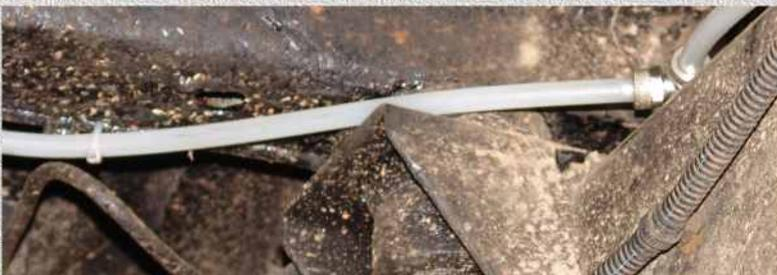
**12. Подсоединяем вывод из коробки передач и раздаточной коробки к трубке, которая идёт от заднего моста к моторному отсеку при помощи фитинга (тройник из комплекта).**
