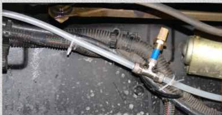
**16. Выводим трубки от заднего и переднего моста в подкапотное пространство, соединяем их при помощи тройника. На другой конец тройника подключаем фильтр из комплекта, который размещаем в самой высокой точке подкапотного пространства.**
