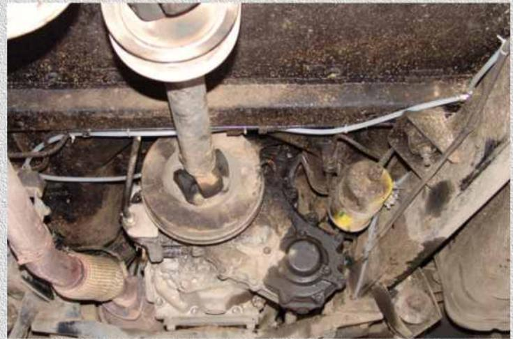
**11. Возможные варианты крепления трубки к лонжеронам автомобиля.**
