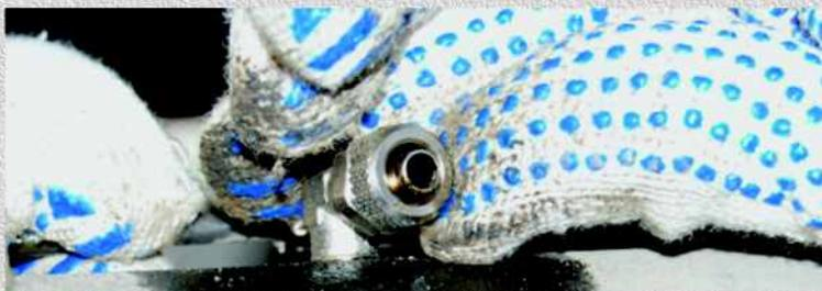
3. Берём из набора уголок и вкручиваем его на место сапуна до упора так, чтоб вывод из уголка смотрел в сторону дифференциала на заднем мосту и в сторону тормозных шлангов на переднем мосту.
