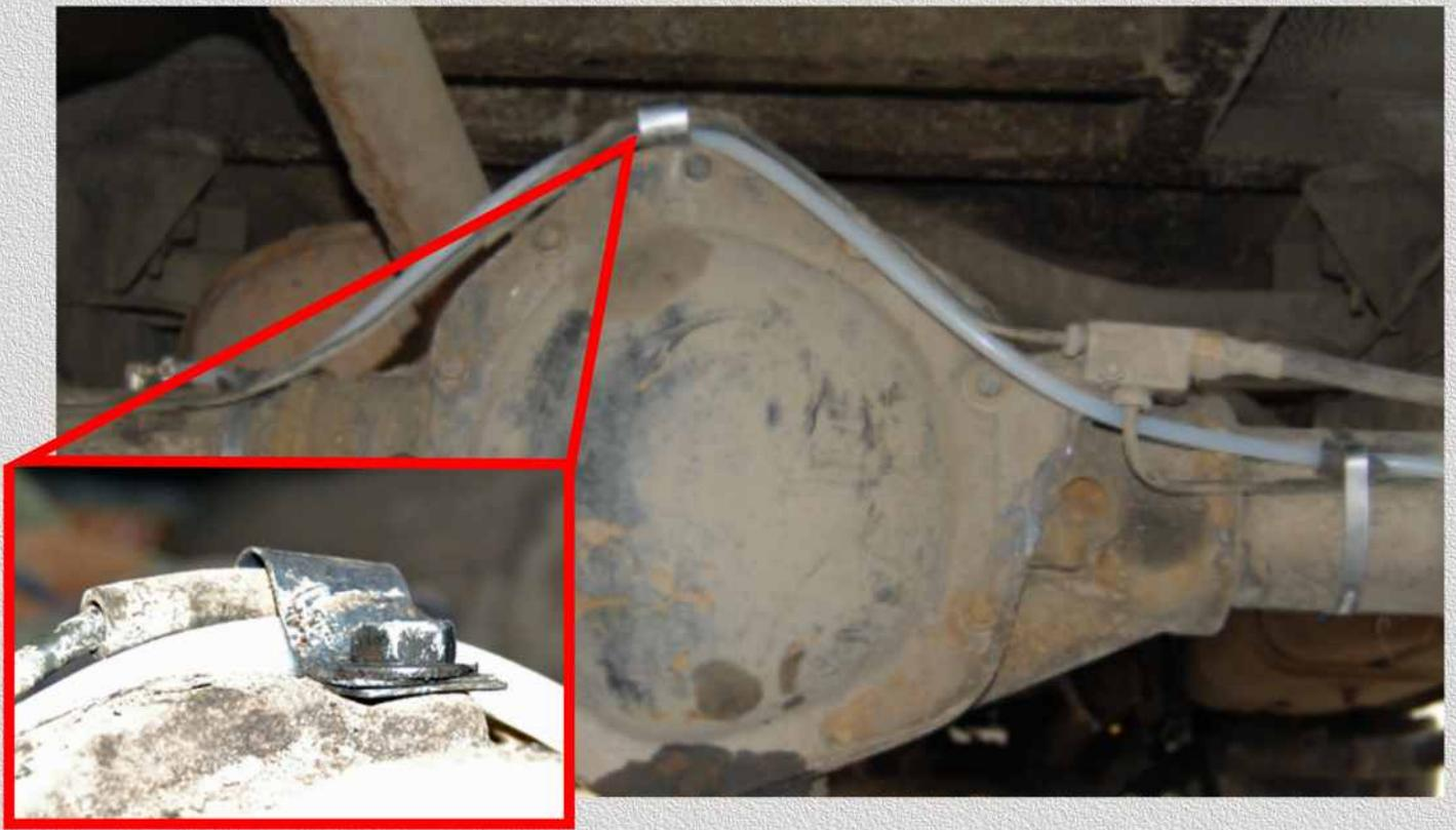
9. Прокладываем трубку по заднему мосту сверху дифференциала. Откручиваем болт крепления тормозной трубки. Фиксируем обе трубки вместе.
